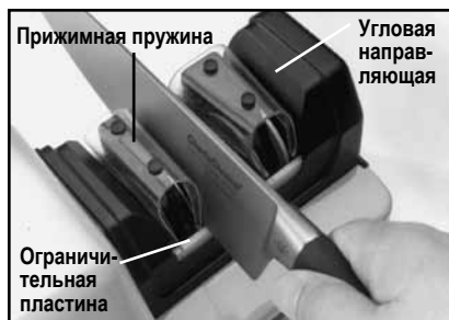
Рисунок 6. Заточка в Устройстве 1: Лезвие вставляется в паз между угловой направляющей и прижимной пружиной, чтобы оно слегка касалось ограничительной пластины.
