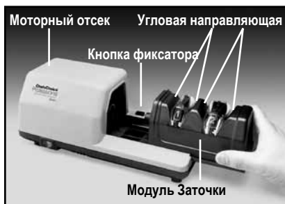
Рисунок 2. Модуль Заточки вставляется в рельсы и сдвигается к моторному отсеку до фиксации. Для отсоединения нажмите кнопку фиксатора и сдвиньте Модуль в сторону от моторного отсека. См. текст.
